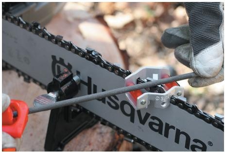
切れ味の良い刃はエンジンの性能と同じように重要です。ご使用のチェンソーが効率的かつ安全に、高い精度で稼働するには、目立ての良い鋭い刃を保つことが不可欠です。ハスクバーナでは、目立てゲージとデプスゲージ調整器具を一体化した独自のコンビゲージを開発しました。このコンビゲージを丸やすりや平やすりと併用すると、確実に正しい目立て角度で作業できます。
